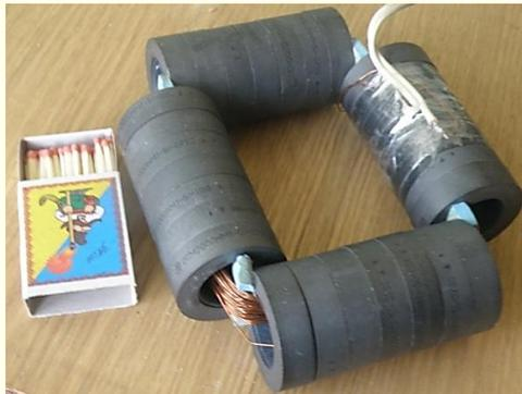
Рис. 1. Обмотка с магнитным экраном из ферритовых колец
